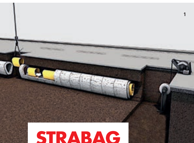
1 Schemaeinbau über Seilwinden / 2 Fertighohrelemente
